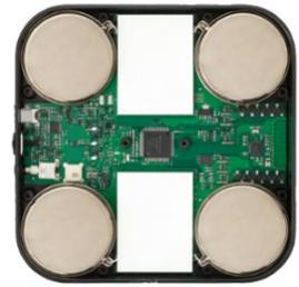
El *Corentium Pro* es un monitor espectroscópico de radón que produce un espectro de energía finamente resuelto, de modo que sólo las señales de las desintegraciones alfa de Po-218 y Po-214 se utilizan selectivamente para calcular la concentración de radón. Sin embargo, se discriminan las señales de los rayos cósmicos (muones), del Po-210 y de los isótopos de la serie de desintegración del torón.
