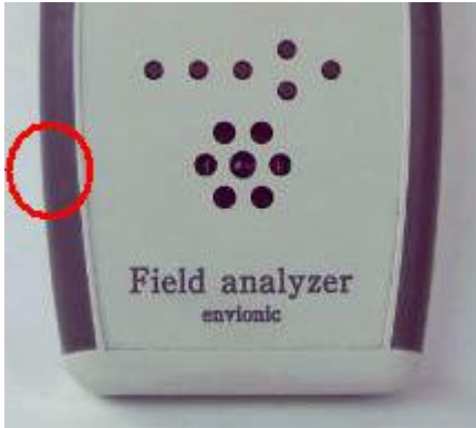
Posición del sensor de campo eléctrico.
