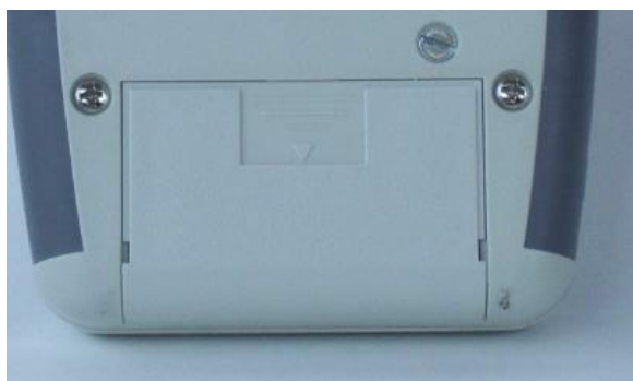
Compartimento de baterías.
