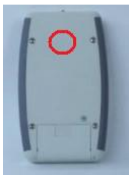
Posición del sensor de campo eléctrico .
