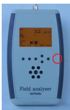
Posición del sensor magnético
