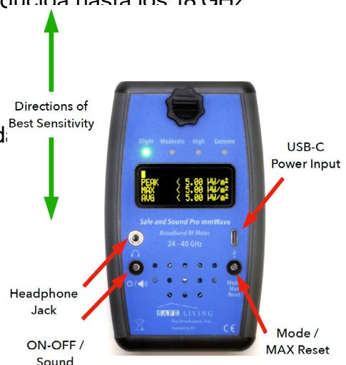
Este medidor sensible es capaz de medir radiación mmWave potencialmente dañina de cualquier fuente digital continua o pulsada. Para ayudar a identificar estas diversas fuentes, Safe and Sound Pro mmWave incluye un altavoz incorporado con niveles de volumen ajustables.. Cada fuente mmWave tiene su propia patrón de sonido único.
